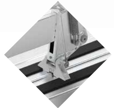
**Professioneller Fliesenschneider „TO PUSH“ für gerade und diagonale Schnitte in einfach und doppelt gebrannten Keramik- sowie Feinsteinzeug-fliesen.** Der Aluminium-Schlitten mit zwei einstellbaren Kugellagern garantiert exaktes Gleiten und höchste Präzision. Dank seines superleichten Gewichts ideal für den mobilen Einsatz.\*
