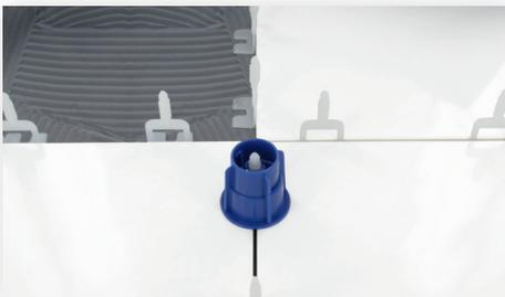
Drehen Sie die Hauben auf die Laschen. Mit einigen Umdrehungen fixieren Sie nun die Fliesen auf eine Ebene. Hauben und Fliesen dürfen keine Kleberrückstände aufweisen, damit kein Abrieb entstehen kann.
