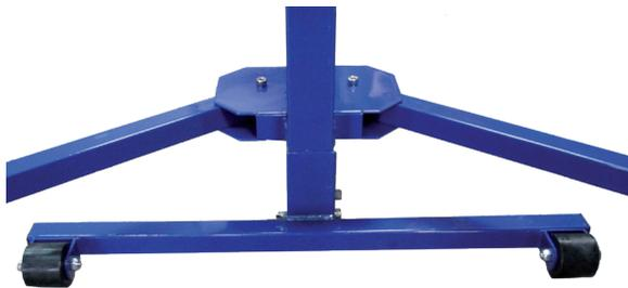
**2** Montieren Sie die beiden Seitenfüsse und den Mittelfuss mit den mitgelieferten 6 58 mm Schrauben und Muttern mit einem 13er Maulschlüssel und einem 6er Sechskantschlüssel an den Rahmenplatten. Setzen Sie den Seitenfuss mit der Bremse auf die Seite des Haupt- und Sicherheitsbremshebels. Der Mittelfuss ist der kürzeste Fuss. **Die Muttern des Mittelfusses müssen fest angezogen werden, da dieser im Gegensatz zu den drehbaren Seitenfüssen fest sitzt.**
