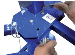
**3** Nach der Montage der 3 Füsse öffnen Sie die 2 Seitenfüsse vollständig und verriegeln sie mit dem vorgesehenen Stift in der Bohrung der gewählten Konfiguration.
